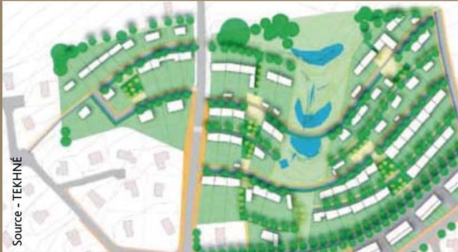
Le plan prend en compte la gestion des eaux de ruissellement par un système de bassins intégrés dans une coulée verte.
