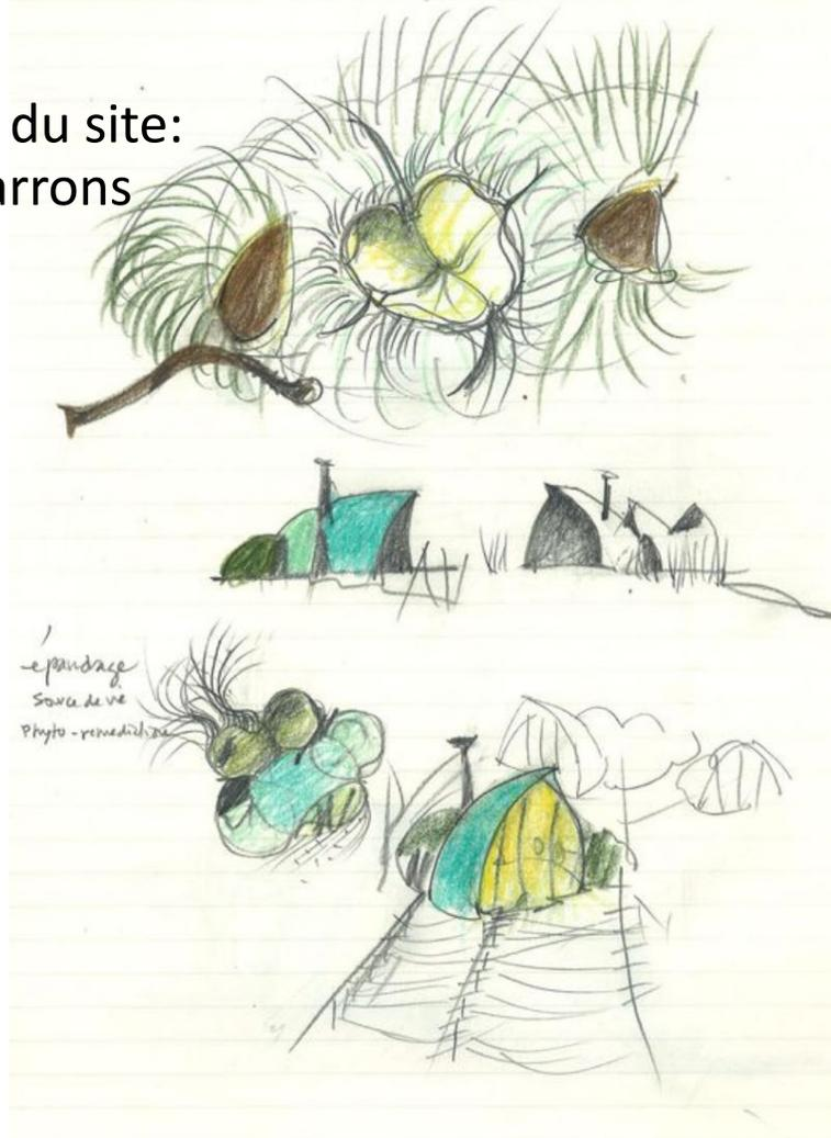
et la réalisation: structure sur pilotis en pin Douglas, toit en ogive bois brut
