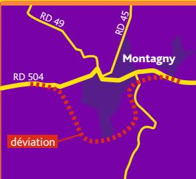
**TRAVAUX :** Longue de 2 km, cette déviation sera empruntée par 5 500 véhicules par jour. D'ici fin 2011, les terrassements, le giratoire de raccordement de la déviation à la RD 504, côté Roanne, les murs de soutènement et le pont seront aménagés. Un important travail de la déviation à la route actuelle, côté Thizy, débutera en 2012.
