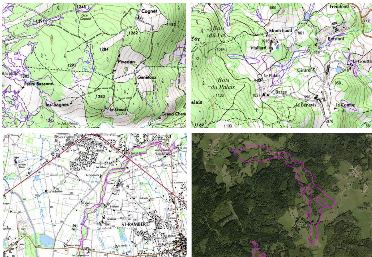
Illustration 5 - Exemples d'identification de zones humides potentielles à partir des cartes topographiques et de l'orthophotoplan : 1 – Figurés illustrant des zones marécageuses, tourbeuses et toponymie (les Sagnes) ; 2 – Zones de sources ; 3 – Vallée plane en bordure de cours d'eau ; 4 – Nuances de végétation
